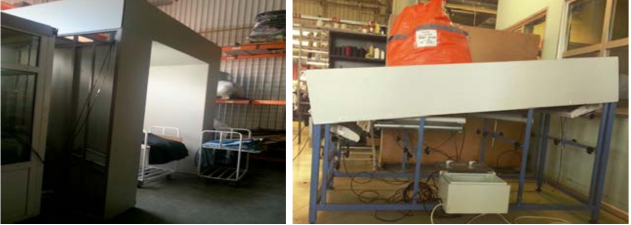
Şekil 4: Kontrol noktası üniteleri ve ürünlerin ünitelerden okutulması
